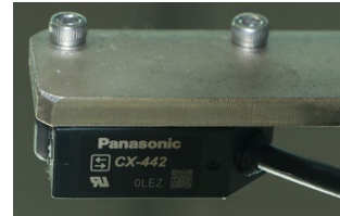
UL安全认证标准的物料检测传感器
