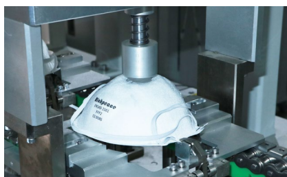
呼吸阀打孔超声波焊接
