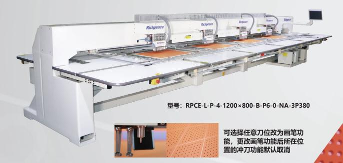
冲孔速度最高可达1000孔/分钟 可选单头、双头、四头机型,多头同时工作,效率倍翻
