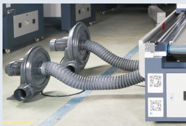
下排烟系统，两台中压2200W压离心风机
