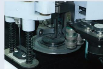
**金刚石自动磨刀**，智能控制裁刀磨损量，保持裁刀锋利，延长裁刀寿命。
