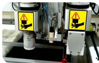
振动刀、圆刀装置
