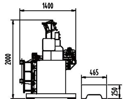
注: 型号: RPQE-NM-SFE-164-305×1574.8-B-2 " CN (50.8)-VR2-DF-3P380 机器尺寸: 5729mm×1400mm×2000mm(长×宽×高)
