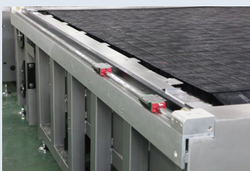
机架整体焊接 , 一次机加工完成, 确保裁剪的高精度。
