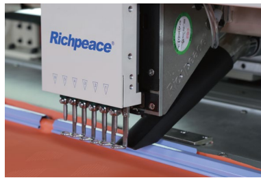
侧出料方式冲杆机构
