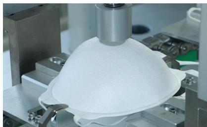
**呼吸阀打孔超声波焊接**
