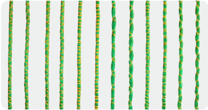
系统配备6种锯齿绣刺绣针法，根据不同绳带特性和花样，可选择合适的针法进行刺绣。
