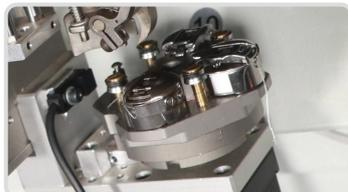
可选配自动换梭系统，减少人工换梭时间，提高生产效率。
