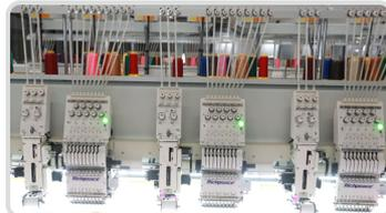
新式面线夹、导线管，独立走线，线道更顺畅，降低断线率。
