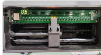
丝杠换色，换色时间缩减至1.2秒/9针，大大提高了多功能刺绣的生产效率。
