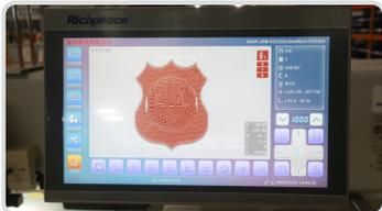
富怡自主研发的全新一代电脑控制系统，15.6寸液晶触控屏，屏幕显示刷新率50ms/次，实时动态显示。
