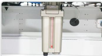
可选配自动加油系统，日本SMC雾化装置，自动控制，油量精准。减少停机维护时间，杜绝油渍污染绣品。
