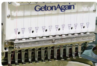
新式面线夹持器，降低断线掉线率。
