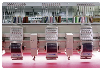
新式面线夹、导线管，独立走线，线道更顺畅，降低断线率。
