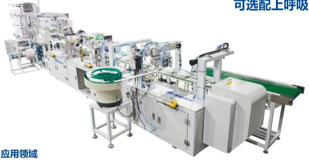
适用于罩杯式口罩的全自动化生产加工。
