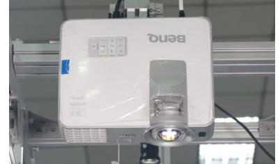
高清投影进行模拟条格以及实时排料的动态显示
