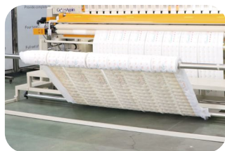
自动收料 Automatic Collecting Rack
