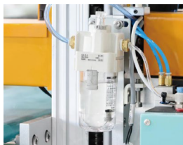
雾化全自动加油系统 Atomization lubricating system
