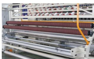
一体随动式上料架,减少面料整理工序,降低人工强度。
