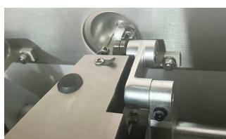
可调压脚机构,适合不同厚度的材料绗缝。
