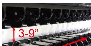
双排机型：双针排间距 3-9 英寸任意调节，下排机头可在半个头距内整体横移,花型设计更为多样。
